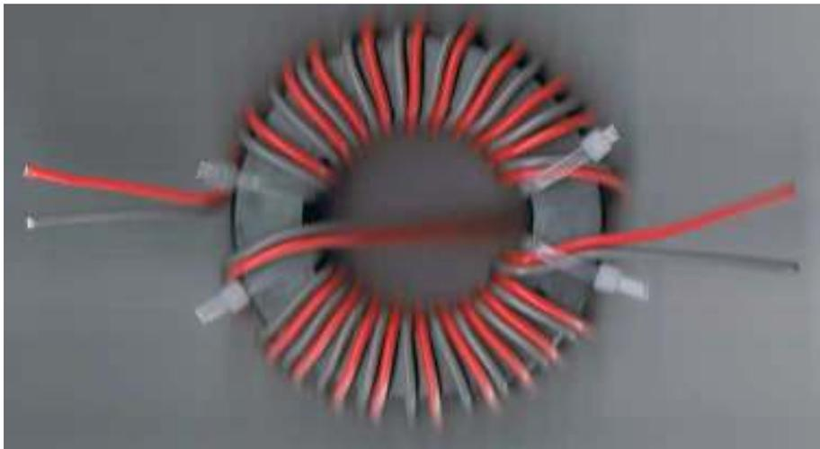
Durch Verwendung PTFE isolierter Litze AWG18 (ca.  $1\text{mm}^2$ ) mit versilberten Einzeldrättchen ist die Spannungsfestigkeit gegeben. Die magnetische Induktion erfolgt nur durch das Potential aus dem Übergang der symmetrischen Antenne zum unsymmetrischen Koaxialkabel. Das kann natürlich in ungünstigen Fällen auch sehr groß werden.
