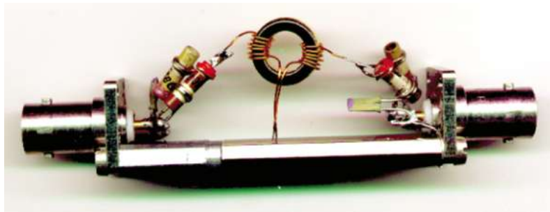
Bild 7: Aufbau für 29 MHz, das lange „Bein“ in der Mitte ist allerdings zu vermeiden
