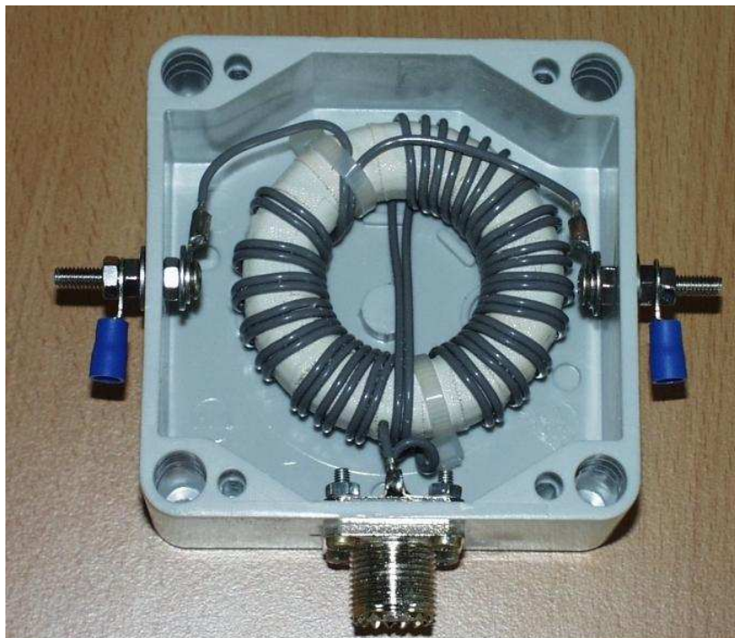
Balun für undefinierte Impedanzen im 85 mm x 85 mm Baumarktgehäuse. Edelstahlschrauben 4 mm, Tropfloch links neben PL-Buchse
