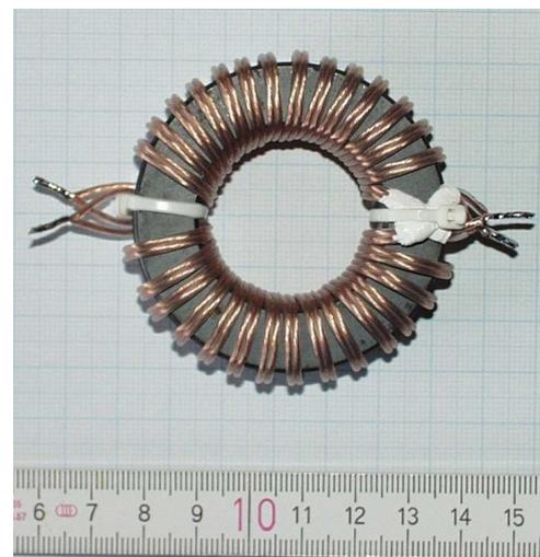
Es ist zu beachten, dass der „Langdraht“ und das Koaxialkabel, und zwar das Stück zwischen Breitbandtransformator  $50 \Omega$  zu  $450 \Omega$  („magnetischer Balun“) und Balun  $50 \Omega$  zu  $50 \Omega$  (Balun 1:1) die strahlende/empfangene Antenne bilden. Beim Koaxialkabel strahlt die äußere Seite der Abschirmung, während der Energietransport im Innern des Koaxialkabels stattfindet.
